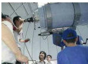
本校創立130周年記念事業の一つとして、卒業生で数多くの反射望遠鏡製作に携わってこられた石川勇氏より寄付されました。直径4mのドームに納める天体望遠鏡は、口径510mm。高校に備えられるものとしては、日本屈指の高精度反射望遠鏡です。
